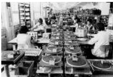
2.6-5 Der erste eigene Plattenspieler B790 in der Fertigungshalle
